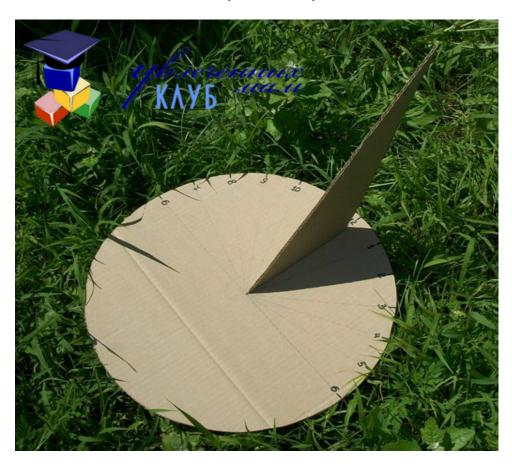
Наши солнечные часы готовы. Теперь выносим их на улицу в солнечную погоду и ориентируем гномон строго на север, так чтобы торчащий вверх уголок был направлен на полярную звезду (север). Время определяем по краю тени, которую отбрасывает гномон. На часах вы увидите солнечное время в вашем регионе. Оно может (и скорее всего, будет) отличаться от официального времени. У нас эта разница составляет около 45 минут.
